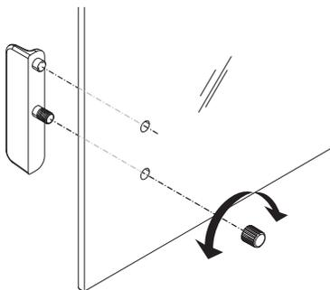
Die Schiebetüren lassen sich zum Reinigen oder Austauschen demontieren. In diesem Fall demontieren Sie als erstes den Griff. Griff erst nach Einbau der Scheibe montieren.
