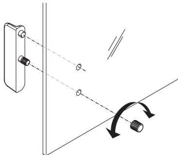
É possível remover as portas de vidro deslizantes para limpeza ou para substituição. Neste caso, é necessário remover a alça primeiro. Instalar a alça após inserção da porta de vidro.
