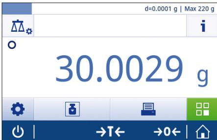
⇒ Nach kurzer Zeit stabilisiert sich die Waagschale. Das Instabilitätssymbol
