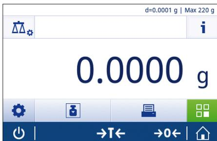
2 Coloque una muestra en el plato de pesaje.
