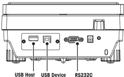
Schnittstellen und Anschlussmöglichkeiten für Peripheriegeräte:
