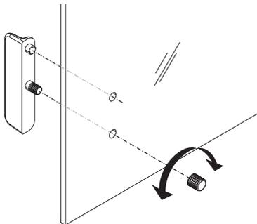
Il est possible d'enlever les portes coulissantes en verre pour les nettoyer ou les remplacer. Dans ce cas, commencez par retirer la poignée. Installation de la poignée après l'insertion de la porte vitrée.
