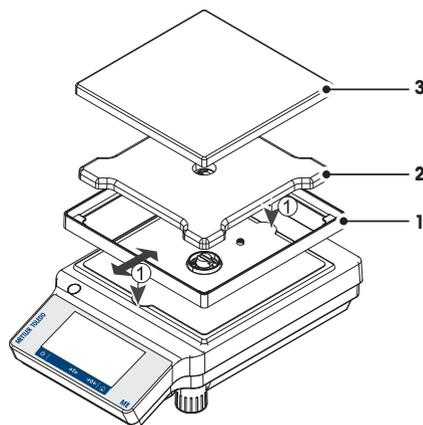
Setzen Sie die folgenden Komponenten in der aufgeführten Reihenfolge auf die Waage:
