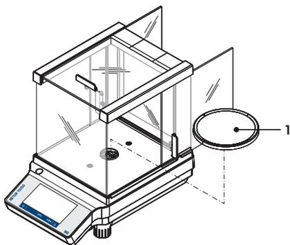
Setzen Sie die folgenden Komponenten in der aufgeführten Reihenfolge auf die Waage:
