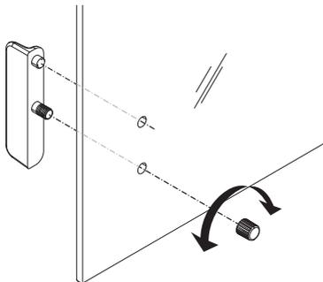
Se pueden retirar las puertas de cristal correderas para su limpieza o sustitución. En tal caso, extraer primero el tirador. Montar el tirador después de colocar la puerta de cristal.
